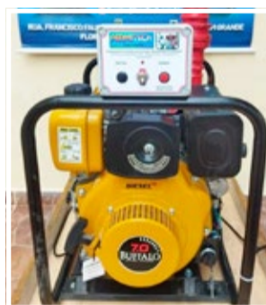
MOTOBOMBA a combustão para hidrantes de bombeiro e motobombas autoaspirante de garagens subterrâneas
